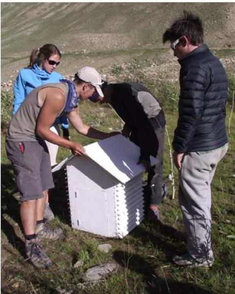
Un charpentier a conçu une station météorologique aérée et étanche que l'on a peinte avec l'aide d'une grande partie du village, enfants et parents. On l'a installée sur un terrain plat pas trop exposé au vent.
